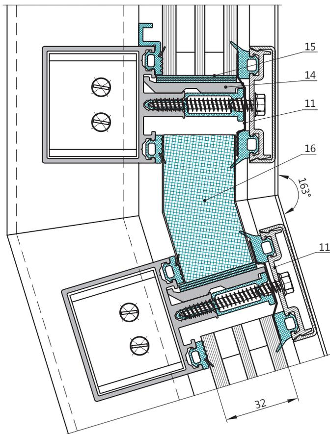
При угловом переходе стоек используется усиленный узел крепления ригелей к стойкам
