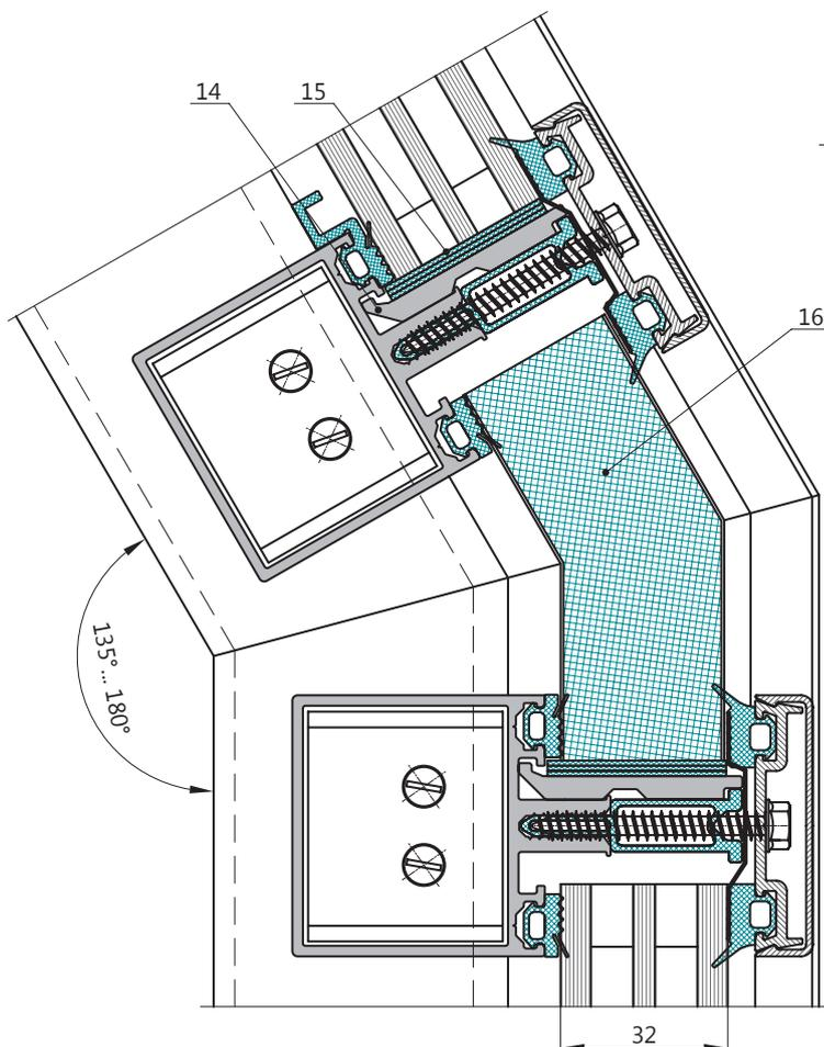
При угловом переходе стоек используется усиленный узел крепления ригелей к стойкам
