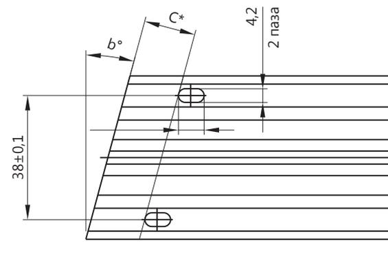
Ригель крепится под углом  $a^\circ / 45..135^\circ$  в горизонтальной плоскости и под углом  $b^\circ / 40..140^\circ$  в вертикальной плоскости
