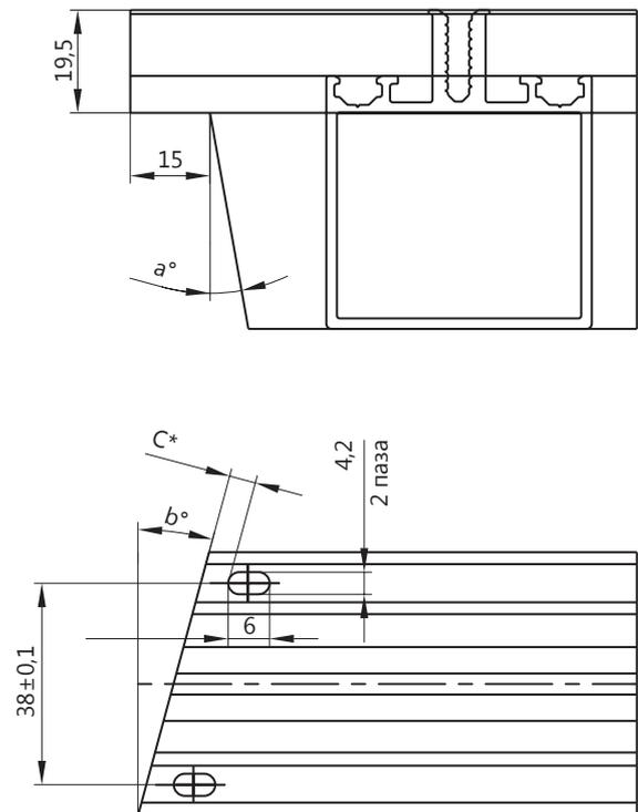
Ригель крепится под углом  $a^\circ / 45..135^\circ$  в горизонтальной плоскости и под углом  $b^\circ / 40..140^\circ$  в вертикальной плоскости
