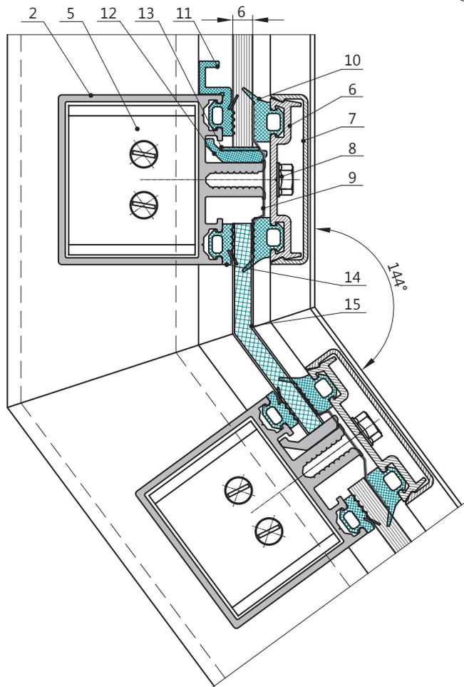
При угловом переходе стоек используется усиленный узел крепления ригелей к стойкам
