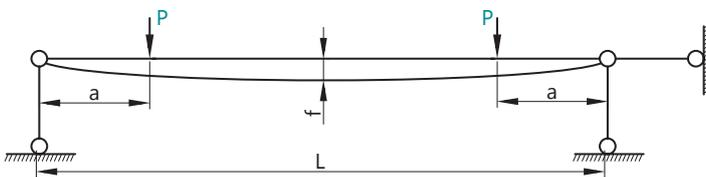
Расчет на прочность элементов, изгибаемых в одной из главных плоскостей, следует выполнять по формуле (п. 4.11, СНиП 2.03.06-85):
