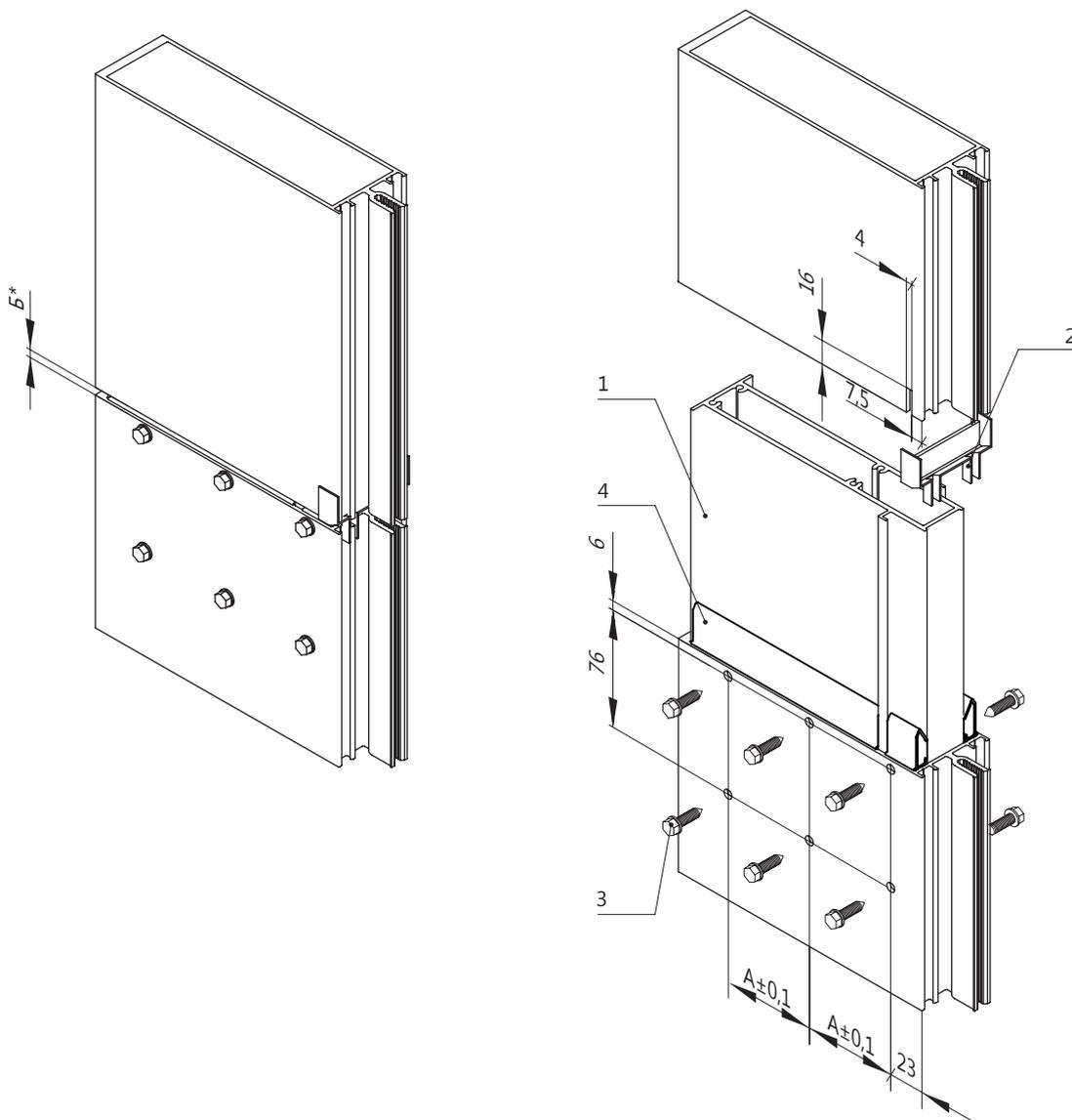
\* Допускаемый зазор между стойками не менее 1 мм на 1 м длины стойки
