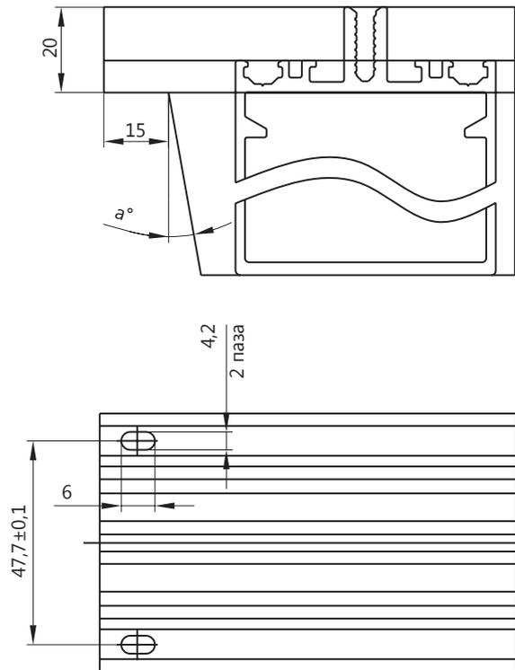
Ригель крепится под углом  $a^\circ / 45..135^\circ /$  в горизонтальной плоскости
