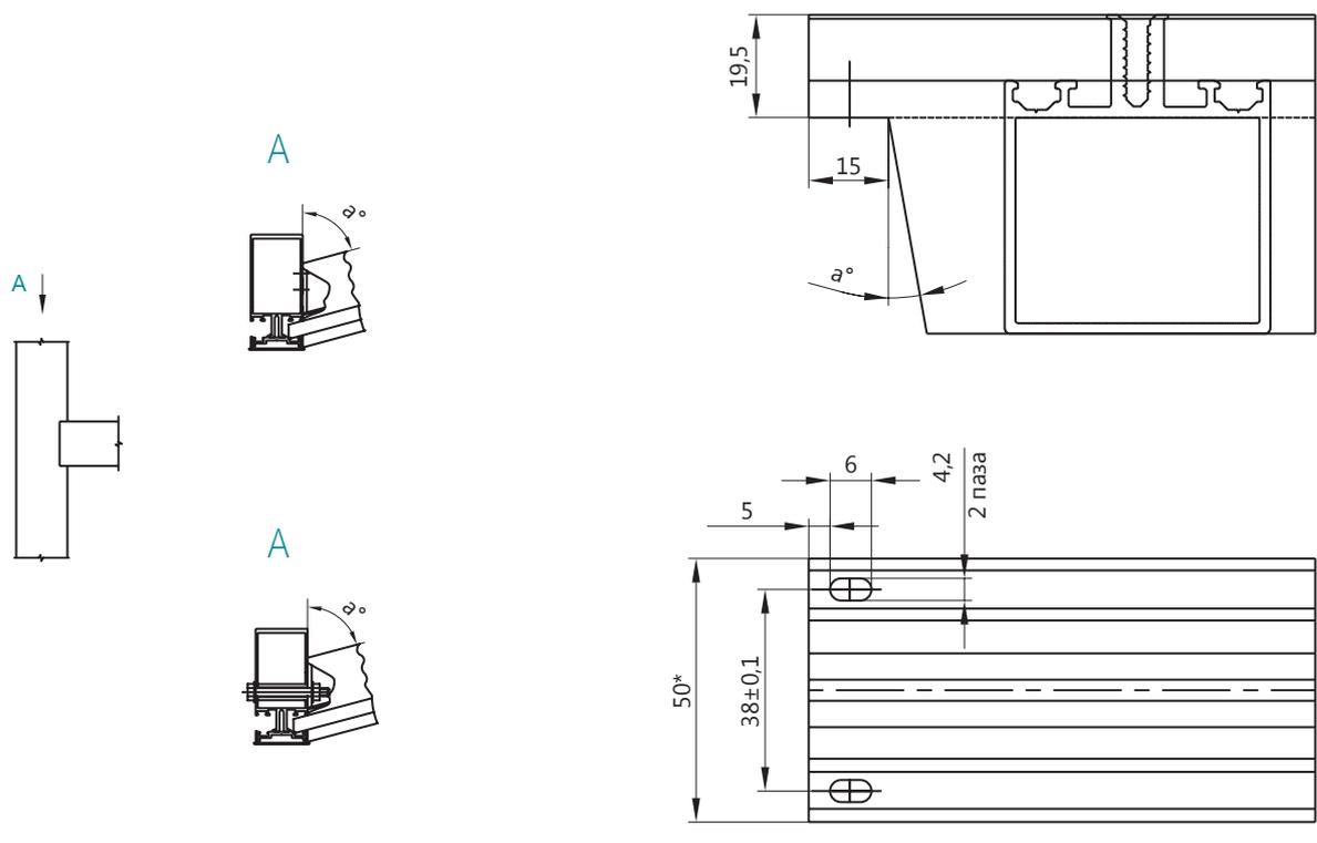
Ригель крепится под углом  $a^\circ / 45..135^\circ /$  в горизонтальной плоскости
