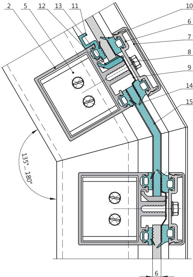
При угловом переходе стоек используется усиленный узел крепления ригелей к стойкам
