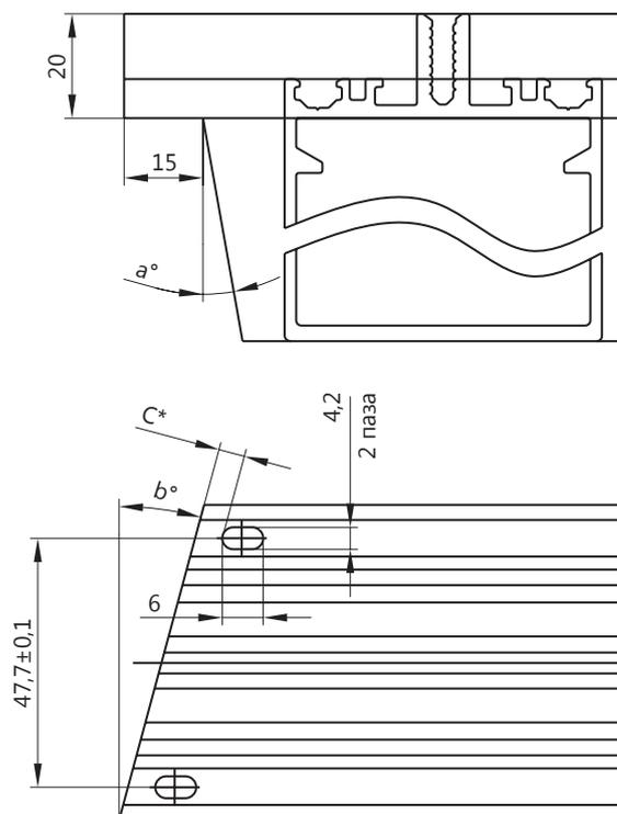
Ригель крепится под углом  $a^\circ / 45..135^\circ$  в горизонтальной плоскости и под углом  $b^\circ / 40..140^\circ$  в вертикальной плоскости
