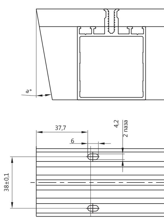
Ригель крепится под углом  $a^\circ / 45..135^\circ /$  в горизонтальной плоскости
