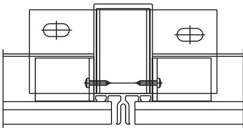
В фасадных конструкциях применяется универсальная закладная ТП-5012. Изготавливается из алюминиевого профиля и в зависимости от длины закладной используется для различных стоек. В верхнем и нижнем узлах крепления используются одинаковые закладные.
